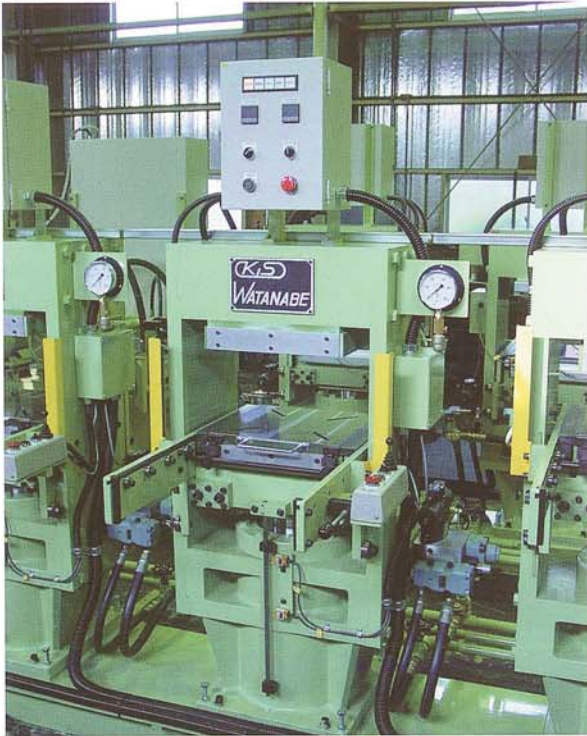
●型締力 100トン、盤面 400×400、 サイドフレーム式、半自動(TP設定式)
